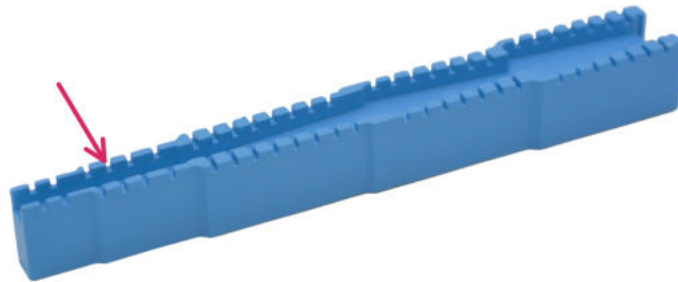
Abbildung 5: Abteil in der Biegelehre für die Schottky Diode.
