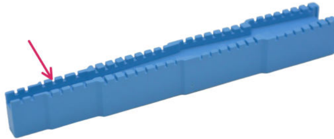
Abbildung 4: Abteil in der Biegelehre für Widerstände.
